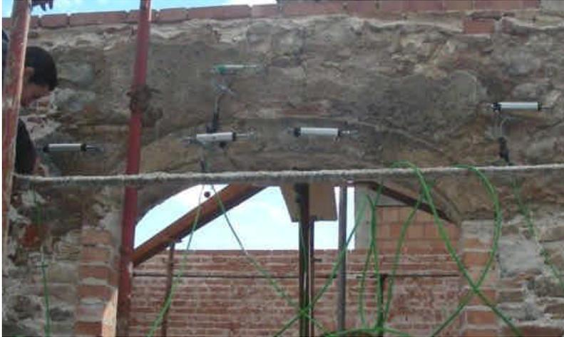
Figura 116. Allocazione dei fessurimetri elettronici per il monitoraggio delle lesioni.
