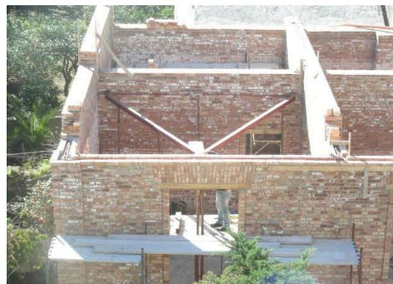
Figure 114 e 115. Posizionamento della macchina di prova in pianta e particolare della testa dove si è applicato il martinetto di spinta. Struttura di contrasto e inferiore (vista dall'interno) e superiore (vista dall'esterno).
